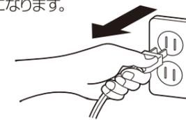
差し込みプラグを抜くときは、電源コードを引っばらずにプラグを持って引き抜く。
